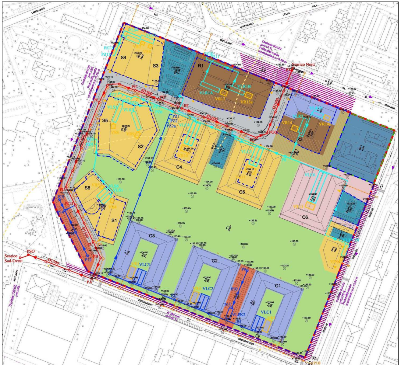
Figura 3 – Rete acque meteoriche - Planimetria generale
