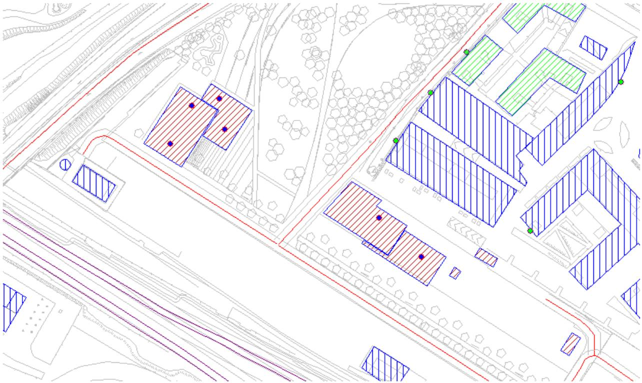
Figura 13 Ubicazione delle sorgenti puntiformi (impianti in copertura) considerati nello scenario dello stato di progetto
