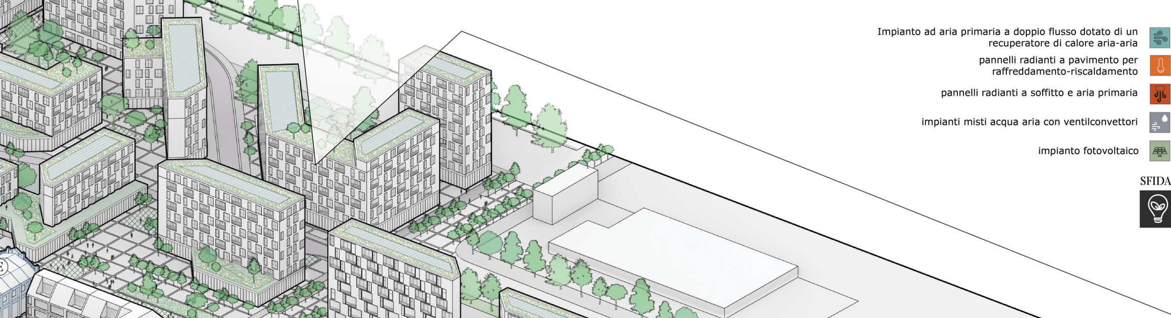
Impianto ad aria primaria a doppio flusso dotato di un recuperatore di calore aria-aria; pannelli radianti a pavimento per l'affollamento/riscaldamento; pannelli radianti a soffitto e aria primaria; Impianti misti acqua-aria con ventilconvettori; Impianto fotovoltaico.
