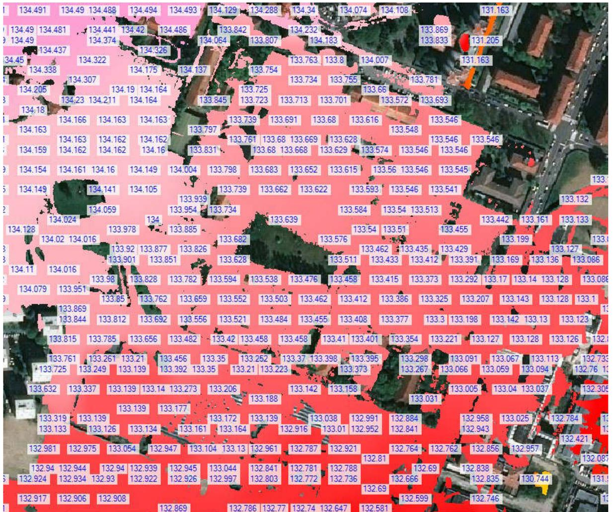
Figura 1.14 - Planimetria di dettaglio delle altezze idriche massime, idrogramma Variante PAI 2017 - Caserma Mameli
