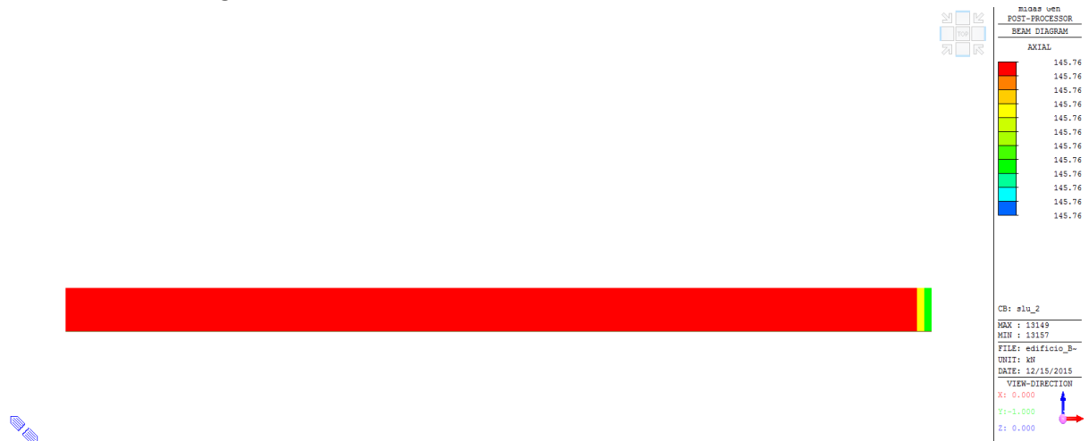
Figura 28. Diagramma dello sforzo assiale nella catena della capriata.
